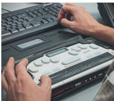
Abbildung 1: Die Braillezeile ist ein Gerät, das Zeichen vom Computer als für blinde Menschen lesbare Brailleschrift darstellt.
